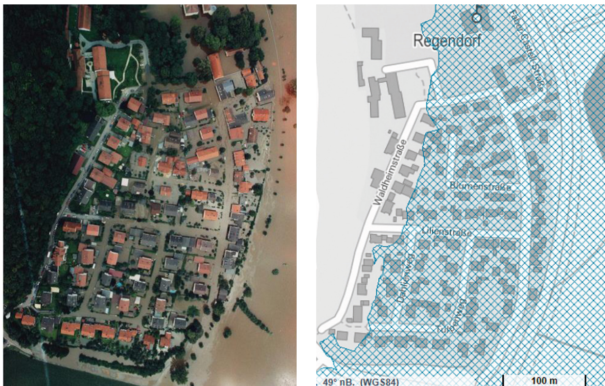
Abb. 3: Wirklichkeit und Modell: Hochwasser 2002 in Regendorf (links) und der dazugehörige Kartenausschnitt aus dem Informationsdienst Überschwemmungsgefährdete Gebiete in Bayern (rechts)
